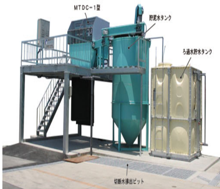
中間脱水処理施設 (貯泥水タンク地上設置型)
